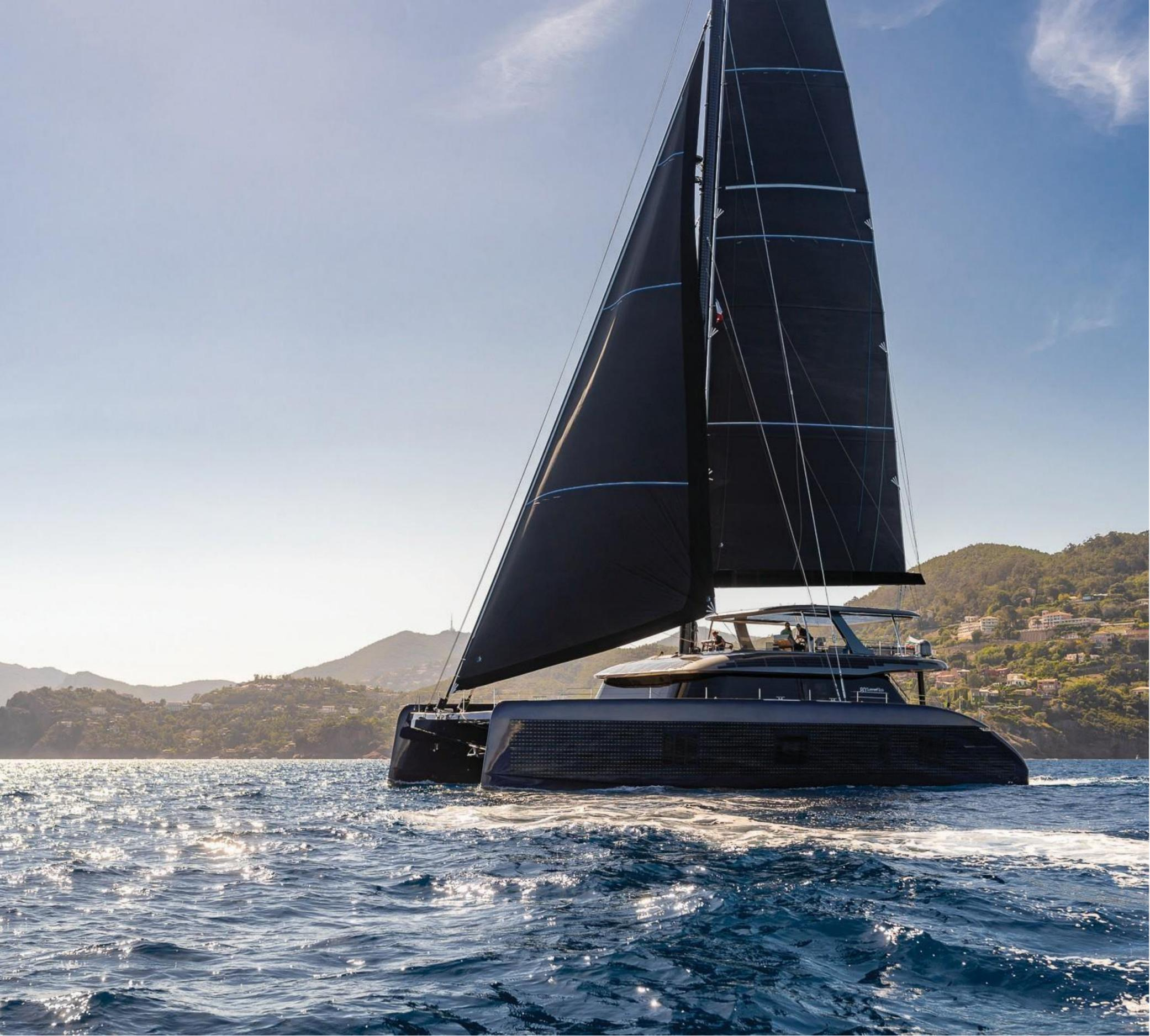
La voilure du Sunreef 80 Eco comprend une grande voile de 200 m<sup>2</sup>, un génois de 155 m<sup>2</sup>, un gennaker de 340 m<sup>2</sup> et une voile d'étai de 70 m<sup>2</sup>. Pendant qu'il navigue, le yacht produit de l'énergie verte en continu grâce à son système d'hydrogénération technologiquement avancé.
